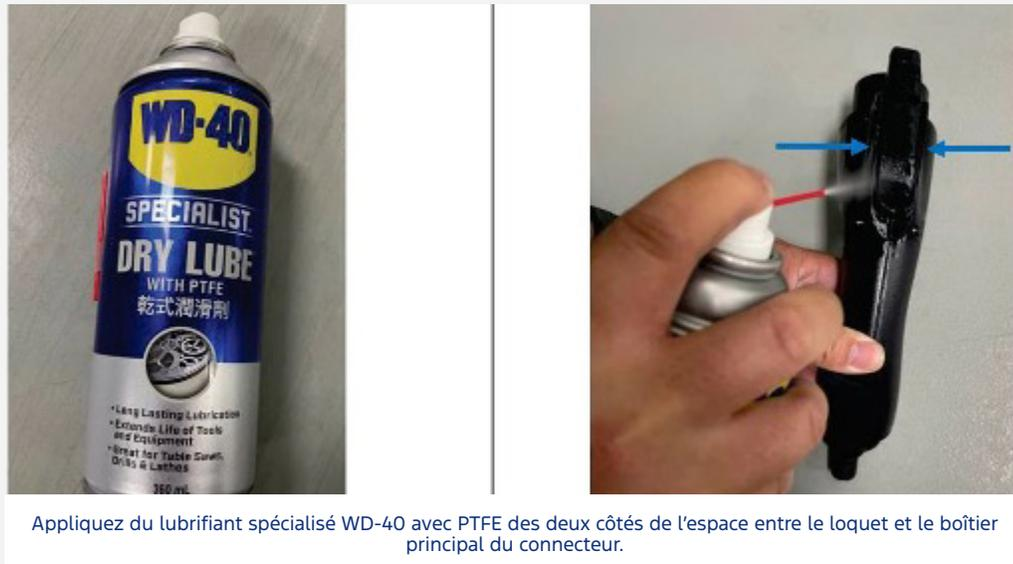
Figure 2.14 Lubrification du loquet du connecteur de recharge avec du WD-40
