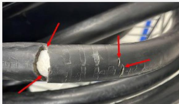
Figure 2.2 Exemples de câbles endommagés
