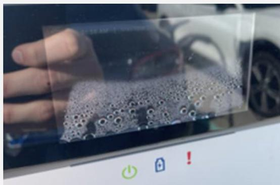
Figure 2.8 Condensation dans l'écran de la borne de recharge
