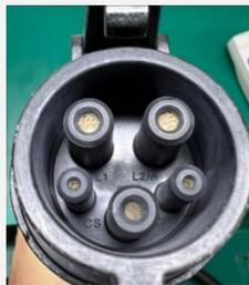
Figure 2.6 Exemple de connecteurs propres
